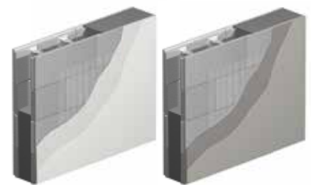
Kuva 16. Harkkoseinän pinnoitus kuivissa ja kosteissa tiloissa.
