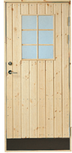
JABO Vapaa-ajan asunnon ovi 18°. Eristetty. Karmi 105 mm. Suora mäntypaneeli. Kaksinkertainen eristyslasi jossa ristikko. Musta potkulevy. 9 x 20 oikeakätinen Tuotenro 413 9 x 20 vasenkätinen Tuotenro 414 9 x 21 oikeakätinen Tuotenro 417 9 x 21 vasenkätinen Tuotenro 418 10 x 20 oikeakätinen Tuotenro 421 10 x 20 vasenkätinen Tuotenro 422 10 x 21 oikeakätinen Tuotenro 425 10 x 21 vasenkätinen Tuotenro 426
