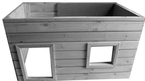
4. Vänd konstruktionen upp och ner och skruva fast bottenskivan med träskruvar 4x40 (medföljer). Antalet skruvar är 18 st.
