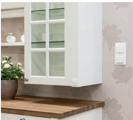
Uudistuneissa valaistuksenohjaukspainikkeissa on 4 painiketta sulkeutuvilla koskettimilla, joiden kuormitettavuus on 1 A. Kullakin painikkeella on oma erikseen kytkettävä valkoinen LED-merkkivalo, jonka kirkkautta voi säätää portaittain. Painiketaulua voi käyttää myös 2-painikkeisena kytkemällä yhden vivun molemmat painikkeet rintaan. Asennetaan sellaisenaan pintaan tai peittämään upporasiaa.
