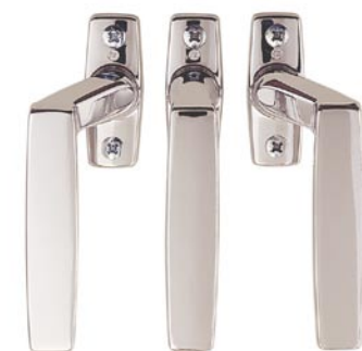
Pitkäsalvanpainike DH83 vasen, suora ja oikea, myös läpikiinnitysversio LK. Materiaali: sinkki. Pintakäsittelyt: kromattu Zn/CR, valkoinen Zn/JVA.
