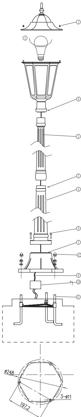
Ei sisälly pakkaukseen. Toimitetaan asennusvalmiiksi johdotettuna pylvään alaosaan ilman kytkenkä-koteloa.
