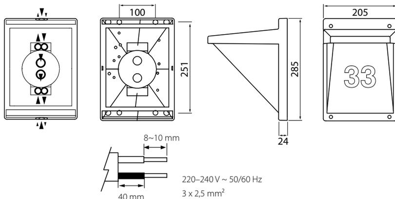
Valaisimen saa asentaa vain sähköalan ammattilainen. Käytä ainoastaan syöttöjännitettä ja taa-juutta joka on merkitty valaisimeen/liitäntälaitteeseen. Kytke virta pois päältä ennen asennusta tai huoltoa. Tämä asennusohje on säilytettävä ja sen on oltava käytössä asennuksessa ja huollossa. Valonlähdettä ei voi vaihtaa. Vaihda tilalle uusi valaisin, jos valonlähde rikkoutuu (⚠).
