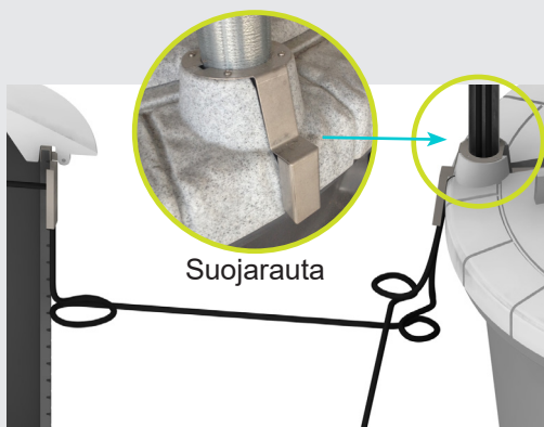
Kuva 9: Maakaapeli ja suojarauta
