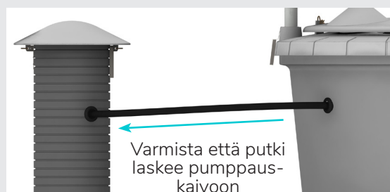
Kuva 12: Täyttöputki laskee pumppauskaivoon
