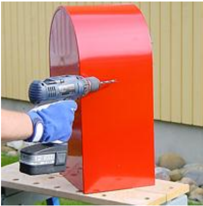
Postilaatikon sivuseinissä on valmiit kiinnitysreikien aihiot.
