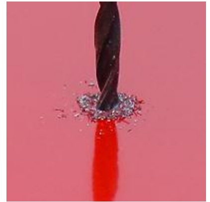
...ja reiät porataan matalilla kierroksilla. Reiät puhdistetaan ja porausjätteet poistetaan.
