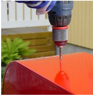
6 mm HSS-metalliterä painetaan reiän aihioon...
