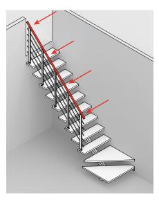
LOAD ON HANDRAIL Max. 0,5 kN/m ~ 50 kg/m
