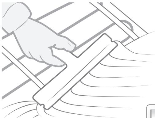
2. Mät kabeln igen för att kontrollera att den inte skadats vid spacklingen.
