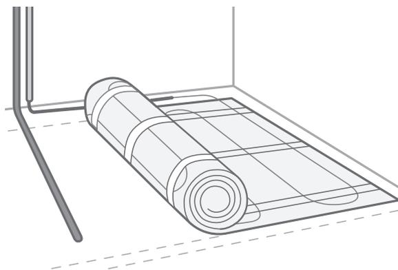
4. Rull ut matten til motsatt vegg. Klipp opp nettet uten å skade kabelen. Ved oppklipping av nettet må ikke kablene ligge nærmere enn 5 cm.
