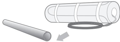
2b. Kytkentäkaapelin ja päädyn välistä liitosta ei saa sijoittaa sisälle tai mahdollisen suihkutilan/lattiakaivon yhteyteen.
