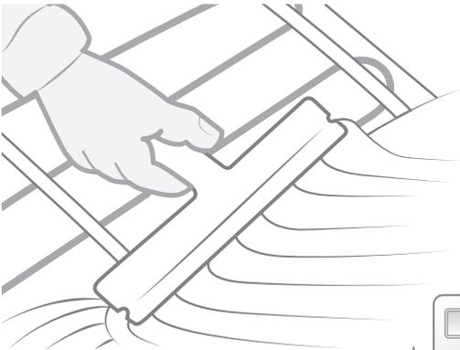
2. Mål kabelen igjen for å kontrollere at den ikke er blitt skadet under sparklingen.
