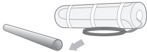
2b. Skjøten til tilkoblingskabel og endeavslutning må ikke plasseres i eller i tilknytning til ev. dusj/gulvsluk.
