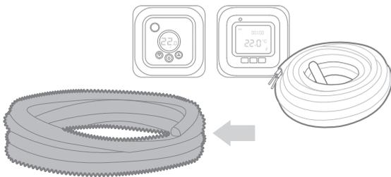
1b. Enden på giverkabelen bør ikke dekkes av tepper eller innredning.
