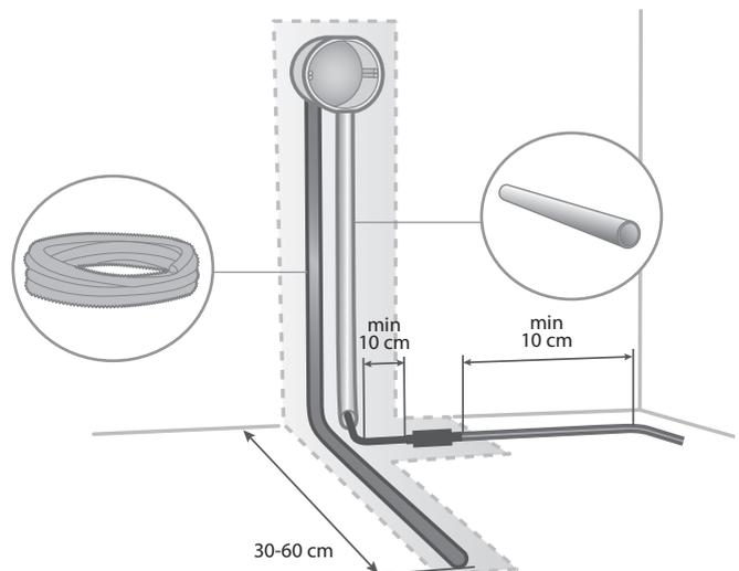
2a. Lattialämmityskaapelissa on 3,0 metrin kytkentäkaapeli. Se asennetaan sähkömateriaalille suunniteltuun VP-putkeen/ muoviputkeen (ei sisälly Thermoflex Kitiin). *Täydennyspake-tista molemmat kylmäkaapelit tulee vetää esiin ja kytkeä rinnan termostaattiin.*
