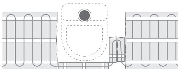
6. Pressa fast mattan med händerna eller fötterna så att den fäster ordentligt. Detta är extra viktigt på grova ytor, t.ex. betong. Använd skor med mjuk sula eller gå barfota för att skydda kabeln. Om du inte spacklar direkt efter utläggning - trampa fast mattan ytterligare en gång precis före spackling. För att ytterligare förbättra vidhäftningen kan golvet primas ytterligare en gång med outspädd primer.
