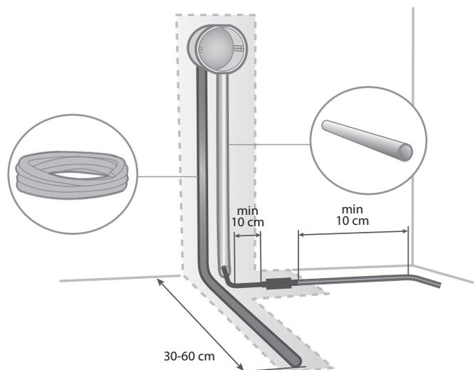
2a. Golvvärmekabeln har 3,0 meter anslutningskabel. Den förläggs i ett VP-rör/plaströr avsett för elmaterial (ingår ej i Thermoflex Kit).
