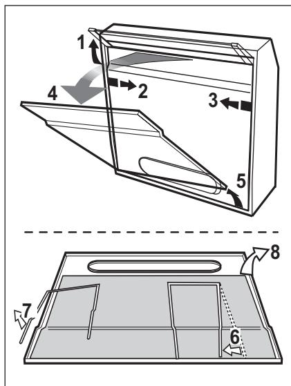
**4.2 - Der NICHT waschbare Aktivkohlefilter** - Je nach der Benutzungsdauer des Herdes und der Häufigkeit der Reinigung des Fettfilters tritt nach einer mehr oder weniger langen Benutzungsdauer die Sättigung des **Aktivkohlefilters** auf. Auf jeden Fall muß der Filtereinsatz mindestens alle 4 Monate ausgewechselt werden. Er kann NICHT gereinigt oder erneut aktiviert werden.
