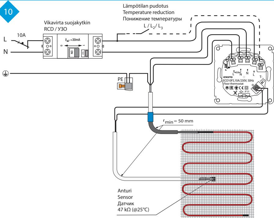
Ensto ThinMat on valmiiksi mitoitettu ohut lattialämmitysmatto, jossa on asennusta helpottava liimaverkko. Enston lämpömatto on tarkoitettu asennettavaksi palamattomalle pinnalle heti parketin, laminaatin, muovimaton tai lattiaklinkkerin alle. Ei sovella asennettavaksi seinään. Parketti-, laminaatti- tai muovilattialle suurin sallittu neliöteho on 100 W/m<sup>2</sup>. Klinkkerille tai vastaavalle kivimateriaalille voidaan käyttää neliötehoa 100 tai 160 W/m<sup>2</sup>.
