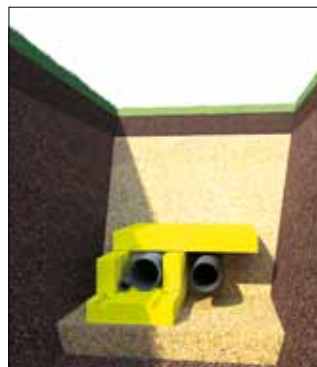
Finnfoam-putkikotelosta valmistetaan helposti lämmönvaihdin, jolla jätevedestä saadaan osa lämmöstä talteen. Sadevesiputki asennetaan kotelon ulkopuolelle, mutta Finnfoamin alle. Näin suojataan sadevesiputkea jäätymiseltä.
