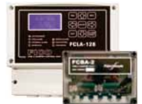
FICO-128. Ohjausyksikkö FCLA-128 voi ohjata maksimissaan 128 palopeltiä yhdessä FCBA-2 kommunikointiyksiköiden kanssa. Jokaiseen kommunikointiyksikköön voidaan liittää 1-2 peltiä ja 1-2 savunilmaisinta.
