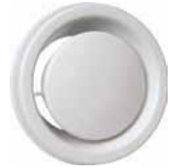
KSO. Poistoilmaventtiili, jota voidaan käyttää kuristimena. Rajoittaa palon ja savukaasu-jen leviämistä.
