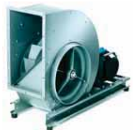
GT. Radiaalityyppisen puhaltimen savunpoistomalli, jossa moottori on sijoitettu puhaltimen ulkopuolelle, pois ilmavirrasta.
