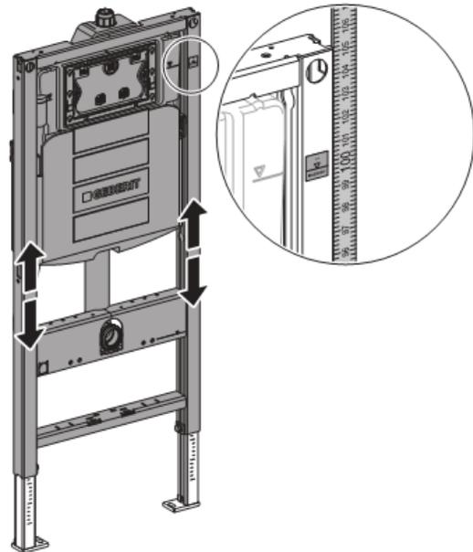
**6** For 98 cm høye elementer gjelder høyden 98 cm fra overkant av elementet og til overkant ferdig gulv.
