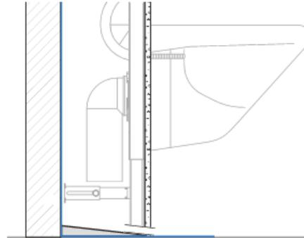
**5** For 112 cm høye elementer gjelder høyden 1 meter fra merket på elementet og til overkant ferdig gulv.
