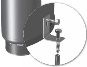
Kuva 3 Teräsrunkoisen säiliön asennus
