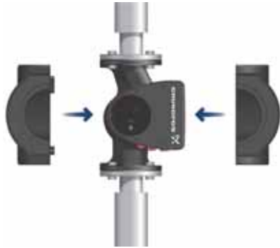
Kuva 18 Lämpöeristysvaippojen asennus MAGNA1-pumppuun
