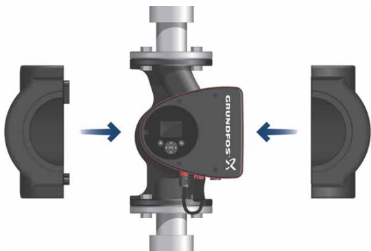
Kuva 47 Lämpöeristysvaippon asennus MAGNA3-pumppuun
