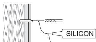
Vid montering på regelvägg med skivor måste väggen alltid förstärkas. Alla skruvinfästningar ska ske i massiv konstruktion, tex betong, i reglar eller särskild konstruktionsdetalj. Skruvinfästning får inte göras enbart i golv-, eller väggskiva. Skruvar för vägg- eller golvfästen samt genomföringar för vatten och avlopp ska tätas mot väggens eller golvens tätskikt.
