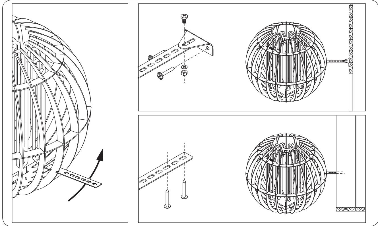
**FI** Kiinnitä kiuas saunan rakenteisiin kiinnityssarjojen (2 kpl) avulla. Kuvassa on esimerkkejä kiinnityssarjojen käytöstä.
