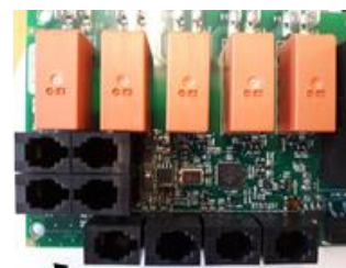
Рис 6 Расположение разъемов RJ 10. Датчик, дверной выключатель, дистанционное управление, дополнительный датчик NTC
