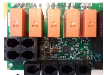
Illustration 6 . Ordre des connecteurs RJ 10. Capteur, interrupteur de porte, télécommande, capteur NTC supplémentaire.
