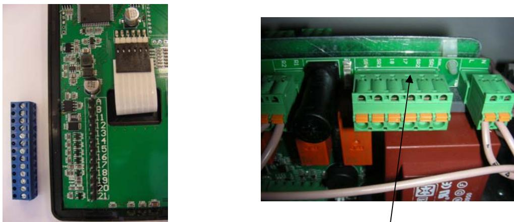
Oznaczenia zacisków połączeń A, B, 11 i 12 panelu sterowania T2
