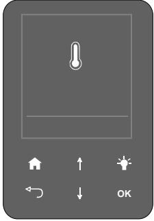
È possibile impostare un limite alle temperature consentite per la cabina sauna sul menu Settings - Service (code 124) - Settings - Temperature limit.
