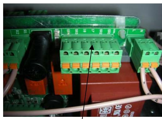
Marcadores de sensores SR1 y SR2 así como, el 17 y 18 de la placa del circuito
