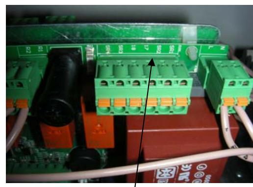
Bezeichnung der Sensoren SR1 und SR2 sowie 17 und 18 der Platine
