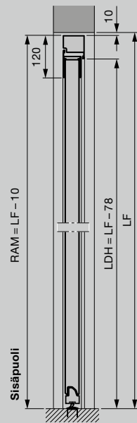
Alumiinisella aukkoon asennettavalla karmilla varustettu sivuovi, profiilityyppi 2 Asennus aukkoon
