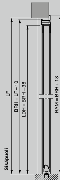
Alumiinisella kulmakarmilla varustettu sivuovi, profiilityyppi 2 Ulkopuolella oleva rajoitin
