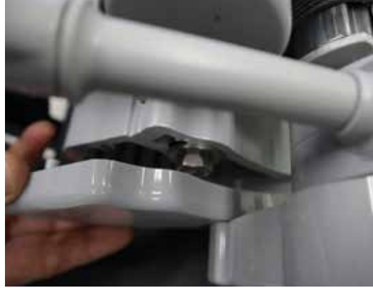
1 Poista päätysuoja kulman säätöyksiköstä.
