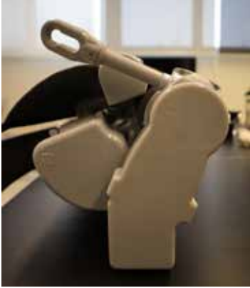
1 Poista päätysuoja kulman säätöyksiköstä.
