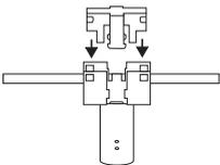
Le raccord HV est un produit convivial qui garantit une installation facile. Il suffit d'introduire le câble dans le réceptacle du raccord et de refermer le couvercle !
