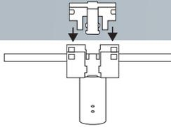
Le raccord HV est un produit simple d'utilisation qui garantit une installation facile. Il suffit d'introduire le câble dans le réceptacle du raccord et de refermer le couvercle !
