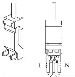
La boîte de jonction est équipée d'un raccord à bornes pour une installation rapide sans vis. L'attache-câble se monte aussi sans vis par simple pression du couvercle vers le bas.
