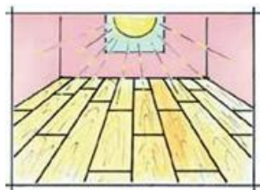
Asenna laudat päävalon suuntaisesti.
