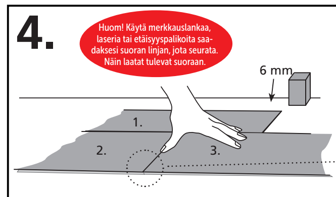
Paina laatan lyhyt sivu suoraan alas. Huom. Jätä 6 mm:n rako seinään ympäriinsä liikuntasaumaksi.
