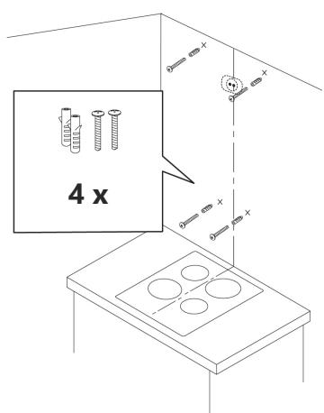
**! Käytä kiinnitykseen** seinämateriaaliin sopivia kiinnikkeitä.
