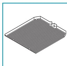
Aktiivihiilisuodattimien tehtävään on pidättää niiden läpi virtaavan ilman hajuja: puhdistettu ilma palautetaan keittiöön suodattimien läpi menon jälkeen.
