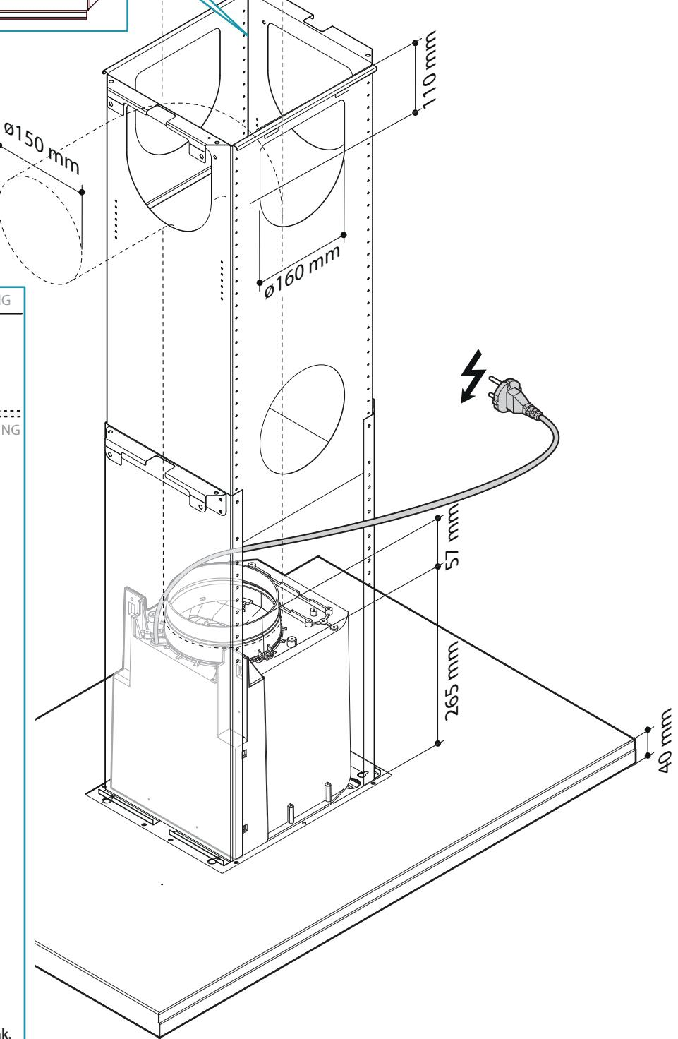
Side outlet which can only be used with false ceiling. Udgang på siden kun til anvendelse med nedhængt loft. Sidoutgang endast användbar med undertak. Sivussa oleva poistoaukko käytettäväissä vain sisäkaton kanssa. Sideutgang som kun kan brukes med undertak.
