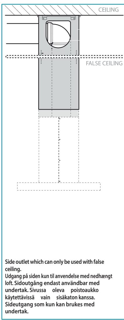
Udgang på siden kun til anvendelse med nedhængt loft. Sidoutgång endast användbar med undertak. Sivussa oleva poistoaukko käytettäväissä vain sisäkaton kanssa. Sideutgang som kun kan brukes med undertak.
