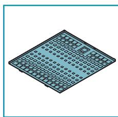
Metallfettfiltren har funktionen att hålla kvar svävande fettpartiklar: dessa sistnämnda underblåser eventuella flammor som avgas under tillagningen när de avlägras på filtren och skapar dålig lukt samt försämrar luftflödet genom att minska kåpans utsugningskapacitet.
