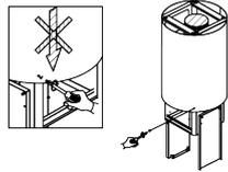
**SV** Fäst fläktens övre del med skruvar i takramen. OBS! Spännskruvarna spänt först i punkt 13, efter att man lagt fläktens nedre del ca 1 cm ovanför övre delen. Detta underlättar att lägga nedre delen på plats.
