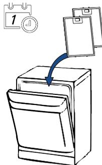
**SV** Fettfiltret kan tvättas i diskmaskinen. Undvik de längsta och hetaste tvättprogrammen. Fettfiltren slits i användning och de bör bytas då deras yta/färg börjar bli sliten eller ljum.
