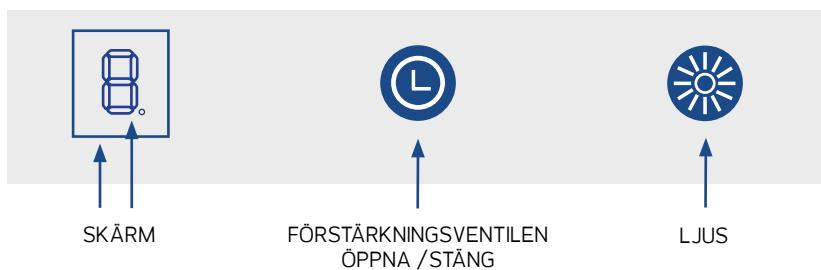
För att välja X3 läget gör följande (installationen måste ske inom en minut efter att strömmen kopplas på): Tryck samtidigt på knapparna och i minst 4 sekunder tills displayn visar nummer 3 (= X3-läge valt) visas på displayen. Spara X3-läget genom att trycka på timerknappen . Driftläget för apparaten kan återställas genom att koppla från och återansluta apparaten till nätsström.
