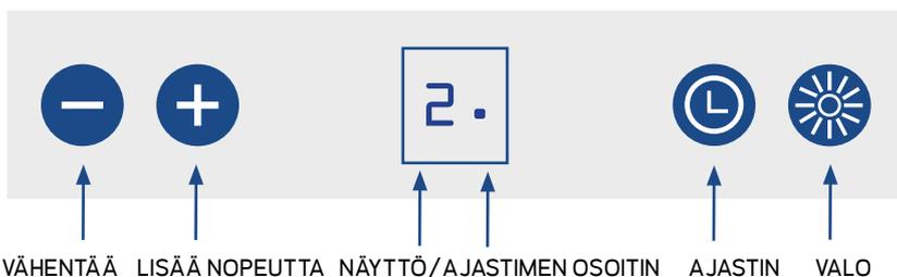
Laite käynnistyy **+** näppäimestä 1. nopeudelle. Painamalla uudestaan nopeus siirtyy joka näppäinkerralla seuraavaksi suuremmalle nopeudelle 2, 3 ja 4. Nopeus 4 on intensiiviteho ja se on päällä 5 minuuttia, jonka jälkeen laite aina palautuu 3. nopeudelle. Nopeutta vähennetään ja laite sammutetaan **-** näppäimestä.
