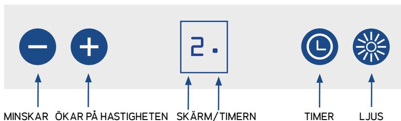
Fläkten startar från **+** knappen på hastighet 1. Genom att trycka på **+** knappen ökar hastigheten alltid till ett steg högre 2, 3 och 4. Hastighet 4 är intensiv nivå som är på en gång på i 5 minuter varefter fläkten går automatiskt till hastighet 3. Hastigheten minskas och fläkten stängs med **-** knappen.
