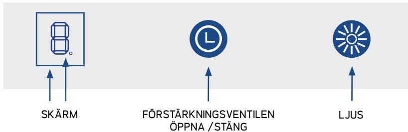
För att välja X3 läget gör följande (installationen måste ske inom en minut efter att strömmen kopplas på): Tryck samtidigt på knapparna och i minst 4 sekunder tills displayn visar nummer 3 (= X3-läge valt) visas på displayen. Spara X3-läget genom att trycka på timerknappen . Driftläget för apparaten kan återställas genom att koppla från och återansluta apparaten till nätsström.
