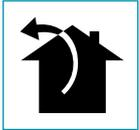
Tässä versiossa savut ja höyryt johdetaan ulkotilaan poistoputken kautta. Tätä varten liesituulettimen ilmanpoistolaitos on liitettävä putkeen, jossa on ulkoinen poistoaukko.
