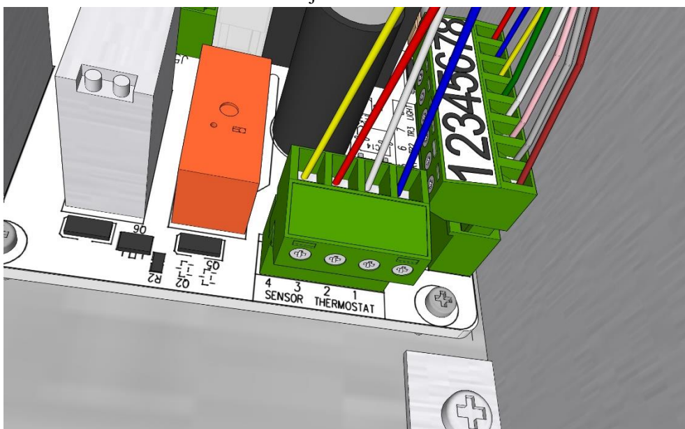
Johtojen järjestys kortilla oikealta vasemmalle.
