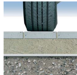
Suodatinkangas tukee erotettuja maa-aineksia.
