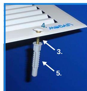
3. Gallrets fästning, hålet skall vara  $\text{Ø}3.5$  mm vid fästning i trädmateriel
