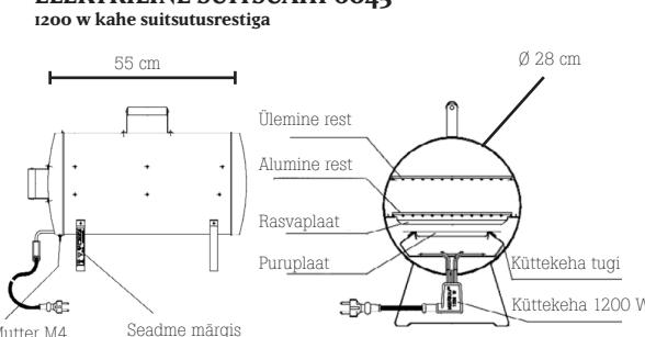
TÄHELEPANU! Alumine rest paigutatakse rasvaplaadi peale!
