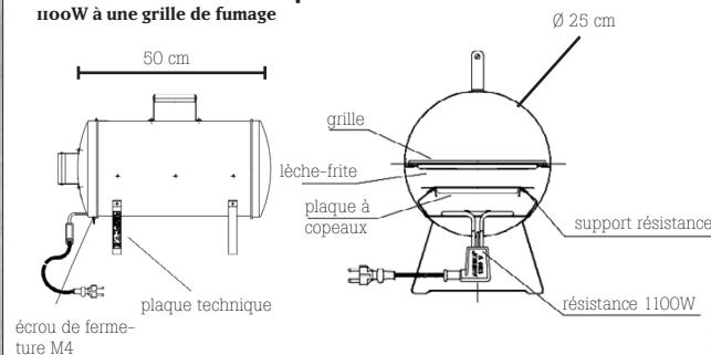
NB! positionner la grille au-dessus du lèche-frite!
