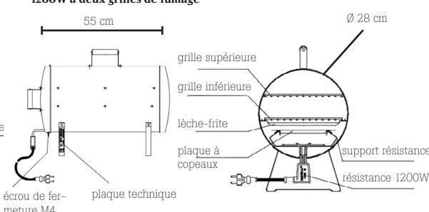
NB! positionner la grille inférieure au-dessus du lèche-frite!
