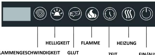
**Das Touchpanel befindet sich in der unteren rechten Ecke der Vorderseite des Geräts.**
