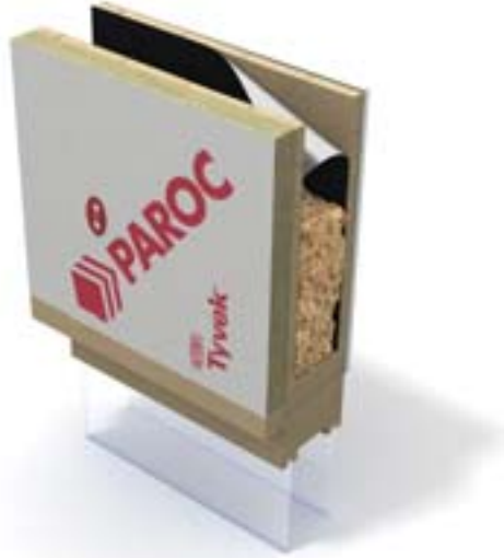
Kuva 1. Aukkojen yläpuolella ja sivuilla sekä eristyksen alapäässä estetään ilmanvirtaukset levyn sisälle kuvan mukaisesti puulistalla. Tiiviiden voi vielä varmistaa teipillä tai sopivalla massalla.
