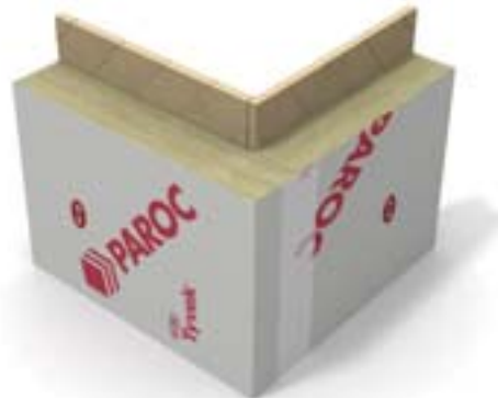
Kuva 2. Tiivis nurkan tuulensuojaus saadaan viemällä toinen levy n. 150 mm yli nurkan ja irrottamalla pintakangasta niin että vain villa leikataan nurkan tasalta. Sen jälkeen pintakangas käännetään yli nurkan ja teipataan kiinni.
