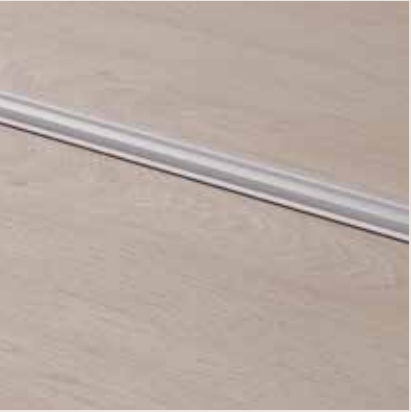
MONITOIMILISTA, HOPEA 1860 × 47 × 16 mm Liikuntasaumalista ja eritasolista samassa. Sopii 0–12,3 mm:n korkeuseroille. Korkeus: 10 mm (asentamattomana) Alumiini. PGPRSILV
