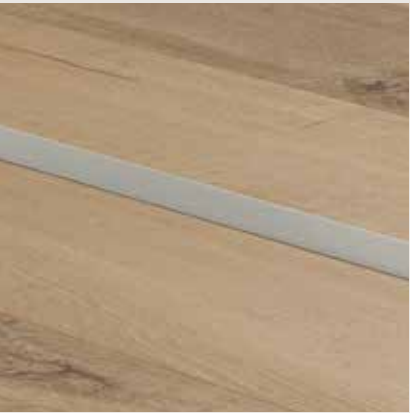
LIIKUNTASAUMALISTA 2000 × 31 × 10 mm Kahden saman korkuisen lattian välisen liikuntasauman peittämiseen. Pinta: alumiinia. SFEXPSILV | SFEXPCOFF | SFEXPCLAY | SFEXPCHAM | SFEXPBLACK
