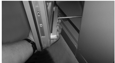
Kuulapää vapautuu lukituskannasta irrotusnappia painamalla.
