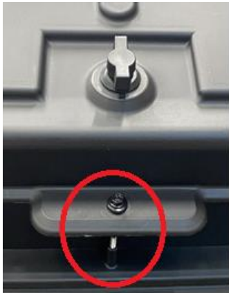
Kuva 10. Kattoluukun lukitus ja ruuvi varmistus
