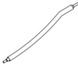
11 Alempi turvaputki, jossa vaahtomuovia
