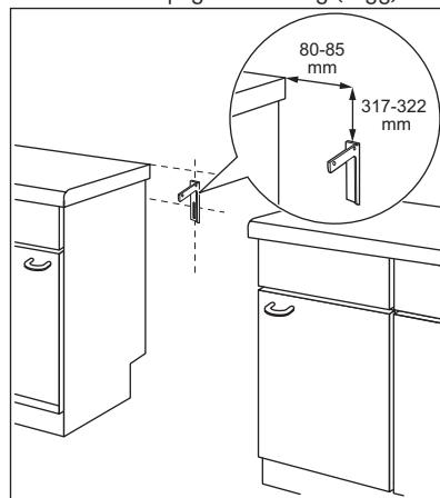
2. Du hittar hålet till vänster på produktens baksida. Lyft produktens framsida och sätt den i mitten av utrymmet mellan skåpen. Om utrymmet mellan bänkskäpen är större än produktens bredd måste du justera sidovidståndet för att centrera produkten.
