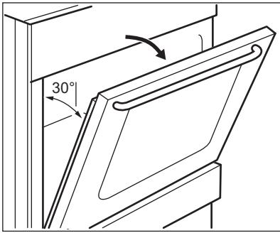
2. Pidä kiinni luukun yläreunassa olevasta listasta (B) kummaltakin puolelta ja työnnä sisäänpäin siten, että kiinnitystiivide vapautuu.
