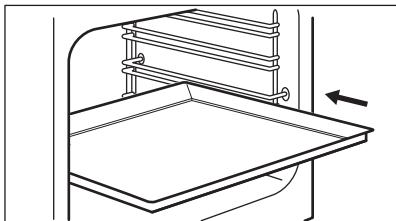
Sätt in bakplåten eller långpannan mellan stegparet på ugnsstegen. Kontrollera att det inte vidrör ugnens bakre vägg.
