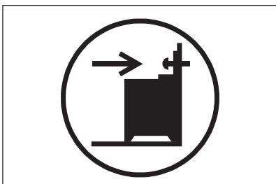
1. Installera tippskyddet 317-322 mm nedanför produktens ovanliga sida, och med 80-85 mm avstånd från produktens sida till det runda hålet på konsolen. Skruva fast det i stabilt material eller använd lämplig förstärkning (vägg).
