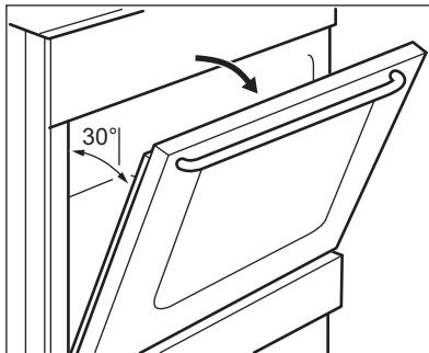
2. Pidä kiinni luukun yläreunassa olevasta listasta (B) kummallakin puolelta ja työnnä sisäänpäin siten, että kiinnitystiiviste vapautuu.
