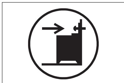
1. Asenna kaatumiseste 317 - 322 mm laitteen yläreunan alapuolelle ja 80 - 85 mm päähän laitteen sivusta kannattimen pyöreään reikään. Kiinnitä se tiukasti ruuveilla vankkaan materiaaliin tai käytä sopivaa vahviketta (seinä).
