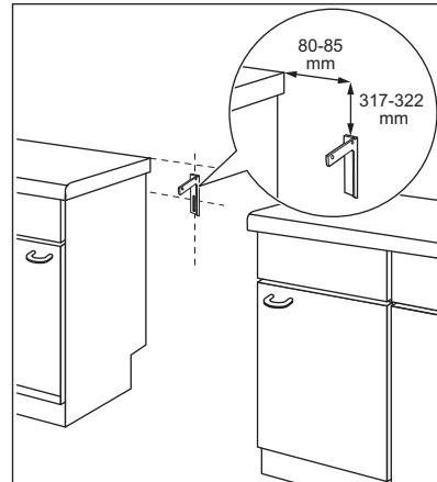
2. Reikä on laitteen takaosan vasemmalla puolella. Nosta laitteen etuosaa ja aseta se keskelle kalusteiden väliin. Jos työtason ja kalusteiden välinen tila on suurempi kuin laitteen leveys, sivumitta on säädettävä laitteen keskittämiseksi.
