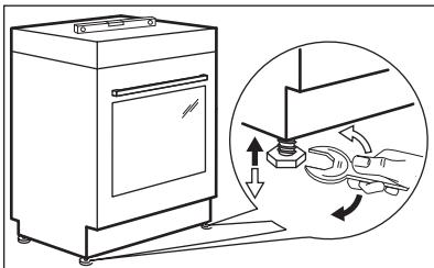
Aseta laitteen ylätaso samalle tasolle muiden pintojen kanssa säätämällä laitteen alla olevia pieniä jalkoja.
