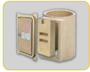
4 Puhdistusluukku, eristekivi ja liitoselementti Liitoselementin korkeus 330 mm (Ø 120 mm, korkeus 660 mm) Aukon sisämitat 130 x 260 mm. Suositellaan lämmityskattiloille.
