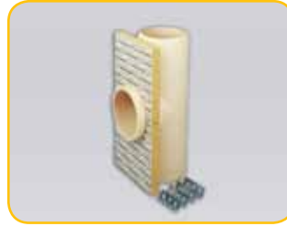
7 Pyöreä liitoselementti ja eristelevy. Korkeus: 660 mm. Liitosaukon halkaisija sama kuin hormikoko (paitsi Ø 120 mm:llä aukko 140 mm)
