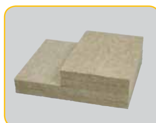
19 Läpiviennin eristepaketti. Lämpötilaluokkaan T400, paksuus 50 mm ja lämpötilaluokkaan T600, paksuus 100 mm. 4 eristelevyä / pkt, korkeus 600 mm.
