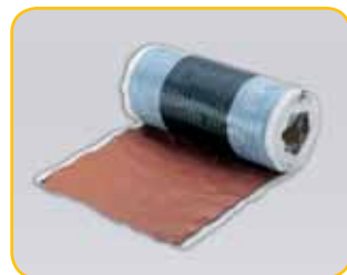
20 Erikoistiiviste Wakaflex tiili- ja peltikatteelle, läpiviennin tiivistykseen. Itseliimautuva. Leveys 280 mm, pituus 1 tai 5 m. Väreinä musta ja tiilenpunainen.
