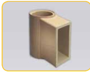
2 Suorakaide liitoselementti. Korkeus: 330 mm Liitosaukon sisämitat: 130x260 mm (ei Ø 120 mm)
