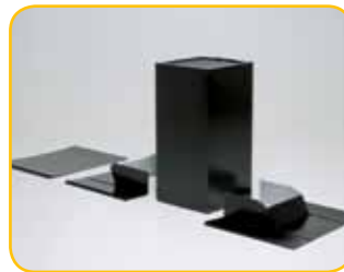
11 Yläosan pellityssarja yksihormiselle sisältää: juuri- ja teleskoopipellin, korkeus max 1,5 m. Tuplahormin yläosan pellityssarja sisältää: juuri- ja ympäryspellin, korkeus 1,2 m. Triplahormille ei pellitystä ole saatavana. Väreinä musta ja tiilenpunainen.
