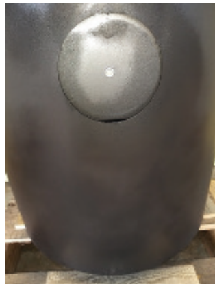
2. Poista kannet. Löysää ruuvia (8 mm) ja poista peitelevy
